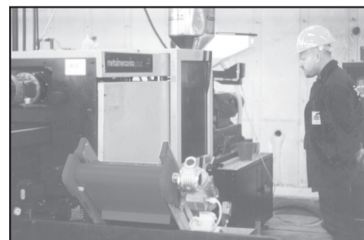
Macchina soffiatrice per produzione contenitori in plastica.
