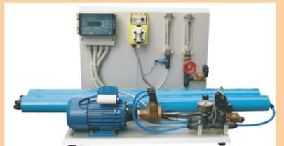
La sperimentazione, programmata in alcune sedi mediterranee, in Tunisia e sulle isole siciliane, prevede la realizzazione di un'unità di dissalazione di acqua marina alimentata esclusivamente con energia solare e capace di produrre circa 200 litri di acqua dissalata al giorno, nella fase di prova. Lo strumento appare notevolmente innovativo e vantaggioso per la fornitura di acqua sia in territori urbani che extraurbani o industriali grazie all'uso di unità di piccole o medie dimensio-
