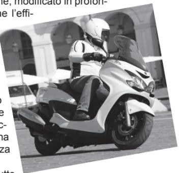
Del tutto invariati sono invece il motore e la ciclistica. Il primo è un monocilindrico bialbero a iniezione di 395 cc, con potenza massima di 34 cavalli a 7.000 giri. Il telaio mantiene l'esclusiva (per la categoria) della costruzione mista in alluminio e acciaio, invariato anche l'impianto frenante, che utilizza una terna di dischi da 267 mm.
