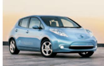
La Nissan Leaf è una vettura compatta a cinque posti nata come auto elettrica. Lunga quattro metri e 45, è equipaggiata con un motore da 109 CV, ha un'autonomia di 160 km e si può ricaricare collegandola ad apposite stazioni ad alto voltaggio (quando saranno realizzate) oppure alla normale presa di casa da 220 V; in questo caso, l'operazione completa di carica richiede otto ore.
