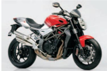
rain) e il controllo di trazione regolabile su 8 posizioni. Scende la potenza massima rispetto al modello precedente, 144 CV a 10.600 giri, e guadagna in regolarità d'erogazione e corposità ai medi regimi.
