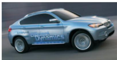
cv equipaggiati sotto la scorta del cambio con batterie; l'interazione continua tra i tre propulsori perché è questo che avviene, garantendo una potenza di sistema pari a 485 cv con una coppia di ben 780 NM.
